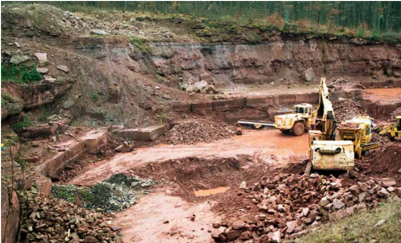
Abb. 6: Solling-Sandstein und Felssandstein mit Karneol-Dolomit-Horizont (blauviolette Schicht nahe der Oberkante) im Steinbruch Kammerforst gegenüber Harrbach. Die im unteren Bereich freigelegte Bank (Ø 1,5 m) wird als Werkstein gewonnen.
