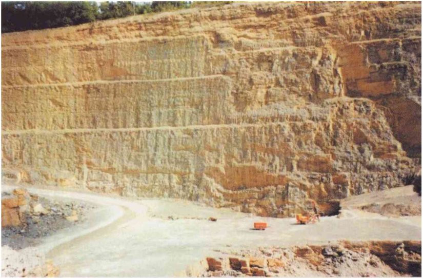
Abb. 9. Steinbruch Albert nördlich Deponie Wirmsthal im Unteren Muschelkalk. Die Schichtenfolge reicht vom Bereich der Konglomeratbänke an der Basis über Oolithbank Beta 2 und Untere Terebratelbank (helles Band im oberen Drittel) bis an die Wellenkalksteinfolge 7. Aufschlußhöhe ca. 55 m.
