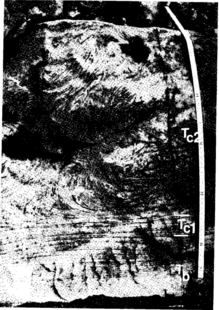
Abb. 29. Karbonatgrauwacke-Bank mit unterem Parallelschichtungsabschnitt ( T_b , 12 cm), flach einfallender Rippelschrägschichtung ( T_{c1} , 4 cm) und intensiver bankinterner Verfältelung ( T_{c2} , obere 41 cm). Basale Bleicherhorn-Serie, Stallauer Bach, 1000 m ü. NN.
