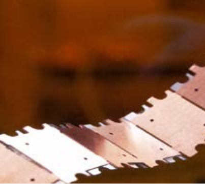
Mechanisch flexibler Batterie- streifen aus segmentierten Mikrobatterien
