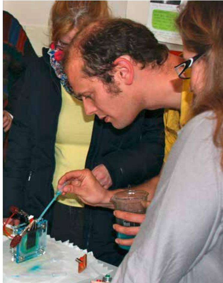
Abb. 4.12-1: Mikrobiologische Brennstoffzelle – Befüllen der Zelle mit einer Hefesuspension
