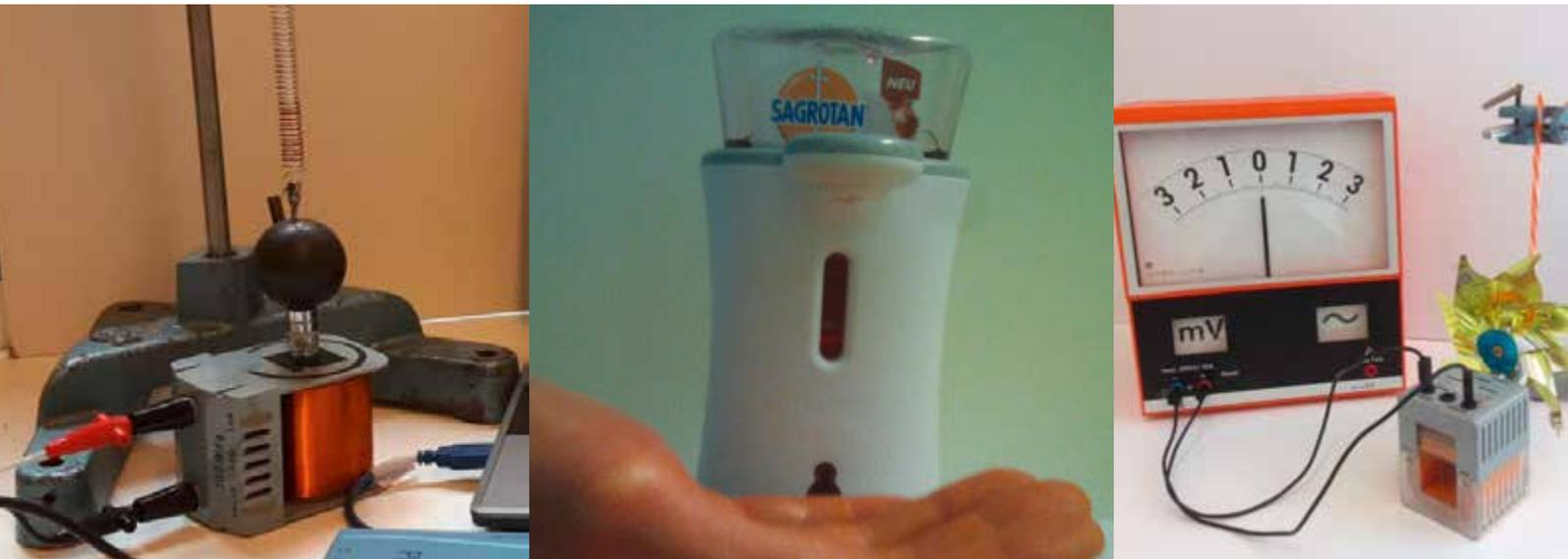
Abb.3.4-3 Verschiedene technische Sensoren, von links: Versuch mit einem Metalldetektor, Seifenspender auf Basis eines IR-Sensors, Windstärke-Sensor
