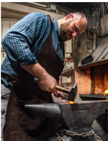
Herstellung eines Meißels in der Schmiede der Dombauhütte
