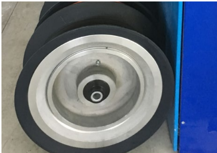
Ersatzteilhaltung – hier Seilrollen Quelle: StMB
