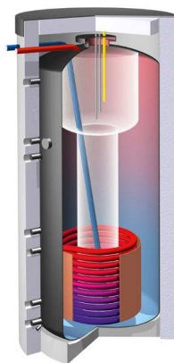
Schnitt durch einen Kombispeicher
